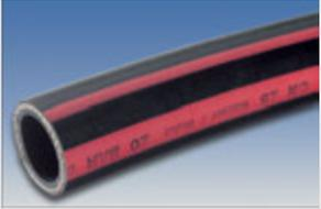
Flexible EPDM      | doublure de renfort, di = 25 mm ; -40 à 100 °C ; max. 10 bar | RKJ 033         |
