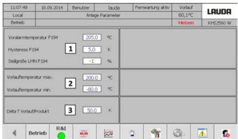
Fig. 51: Seuils de température
